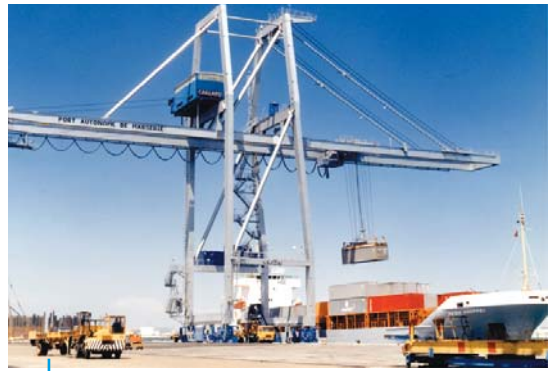
Seaport gantry crane / Grue à portique port maritime
