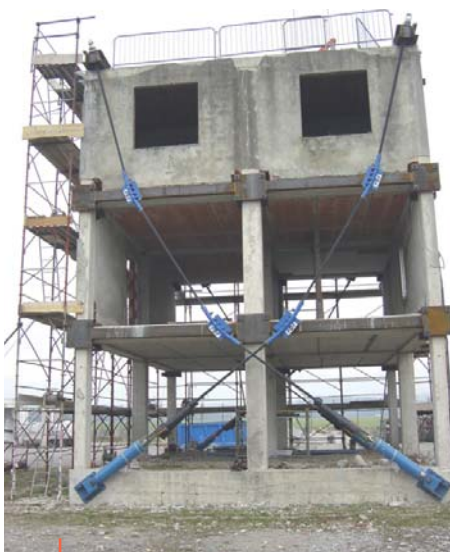
Preloaded spring damper, type « Spider » Patented design Ressort amortisseurs précontraints, type « Spider » - Conception brevetée
