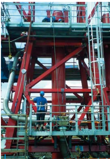
1 Piston Accumulator SA 820, Stroke 7 650 mm 1 Accumulateur à Piston SE 820, Course 7 650 mm
