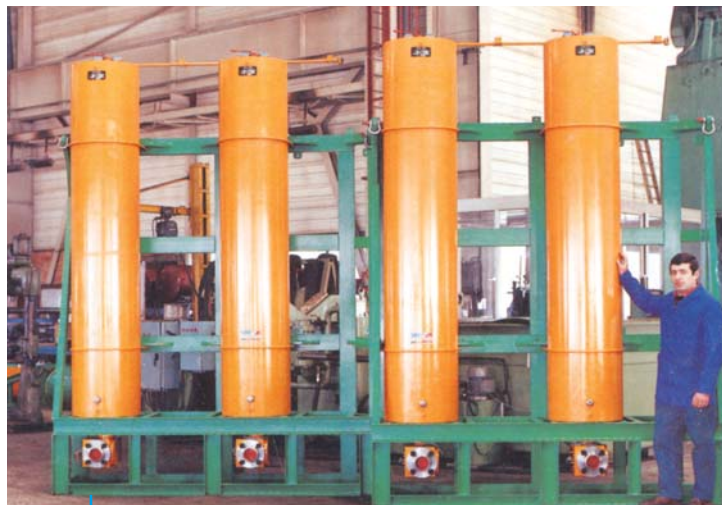
12 Piston Accumulators dia. 420, Stroke 1 870 mm - Test table 12 Accumulateurs à Piston dia. 420, Course 1 870 mm - Table de test
