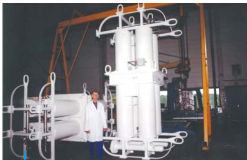
8 Piston Accumulators Dia. 4 020 x 1 560 x 1 560 mm Aircraft carrier Charles de Gaulle 8 Accumulateurs à Piston dia. 4 020 x 1 560 x 1 560 mm Porte-avion Charles de Gaulle
