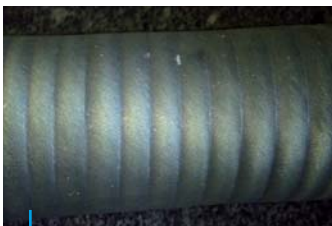
Sample after weld overlay process Echantillon après procédé de recouvrement par soudure
