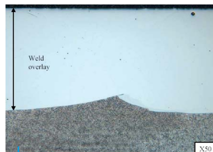
Echantillon de recouvrement par soudure : Épaisseur mesurée de 1 à 1,2 mm - Aucun défaut n'est examiné.
