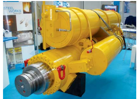
Wireline Tensioners DA 540 x 480, Stroke 3 810 mm + HP Accumulator dia. 580, Stroke 3 710 mm + LP Accumulator dia. 304, length 3 450 mm Tensionneurs Wireline DE 540 x 480, Course 3 810 mm + Accumulateur Haute Pression 580, Course 3 710 mm + Accumulateur Basse Pression 304, Longueur 3 450 mm
