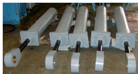
Telescopic Cylinders with KERADOUCE® coating Dam in West Virginia, USA (Army Corp of Engineers) Vérins télescopiques avec tiges en revêtement KERADOUCE® Barrage de Bluestone Lake en Virginie de l'Ouest, USA (Army Corp of Engineers)
